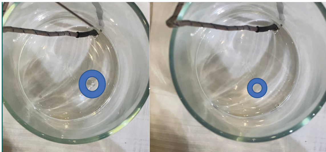
Рис. 5 Размер капли спирта через 2 секунды и через 50 секунд после начала левитации (слева направо соответственно)
